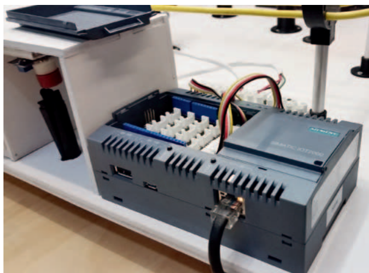
Il gateway Simatic con a bordo le schede per il controllo di movimento, che con Arduino sono chiamate 'shield'
