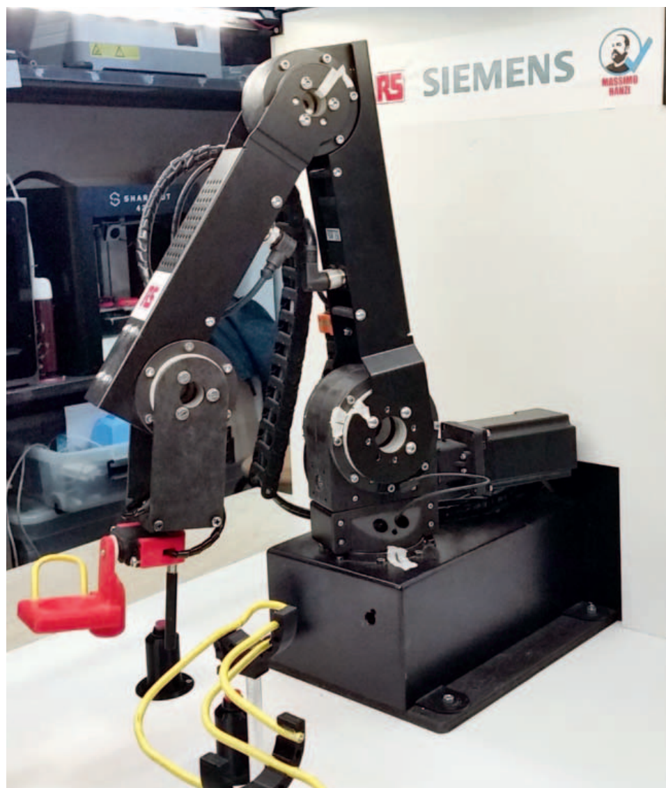
L'applicazione dimostrativa del nuovo gateway Simatic, con il braccio robotico Robolink D
