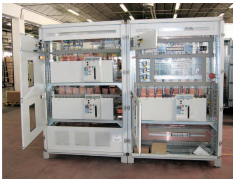
Quadri gemelli, con carpenterie Mas4000 equipaggiati con interruttori aperti da Megabreak 6.300 A e 5.000 A nello stabilimento BTicino di Tradate
