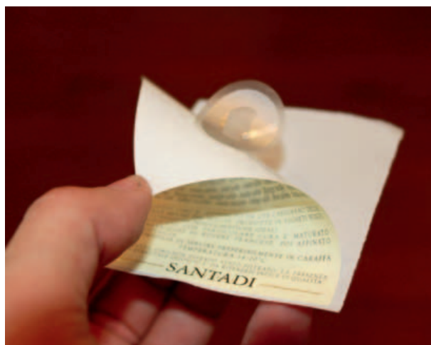
Il DNA Tag NFC di forma rotonda è ben visibile sul retro-etichetta della bottiglia di Cantina Santadini
