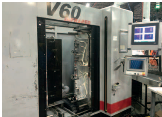
Le fasi di saldatura della griglia di sbrinamento controllate dalle termocamere Flir
