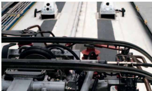
Esempio di installazione del sistema Tocis su un locomotore di test
