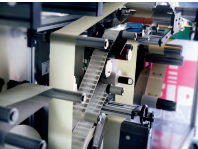
Tra i 'plus' distintivi del processo NFC figura l'accoppiamento automatico dell'etichetta cartacea della bottiglia di vino con il DNA Tag NFC, grazie all'Rfid Label Inserting Machine di Rfid Global
