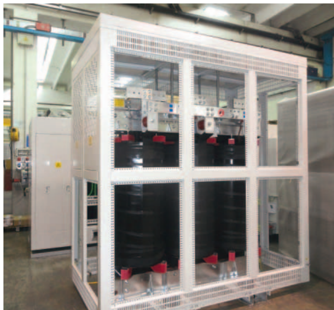
Trasformatori BT/BT da 2.900 kVA in allestimento presso lo stabilimento BTicino di Teramo
