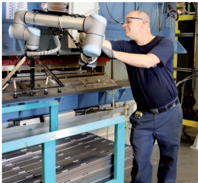
I robot sono in alluminio, non necessitano strutture o spazi operativi significativi per essere installati
