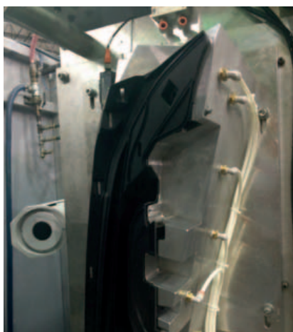
Le fasi di saldatura della griglia di sbrinamento controllate dalle termocamere Flir
