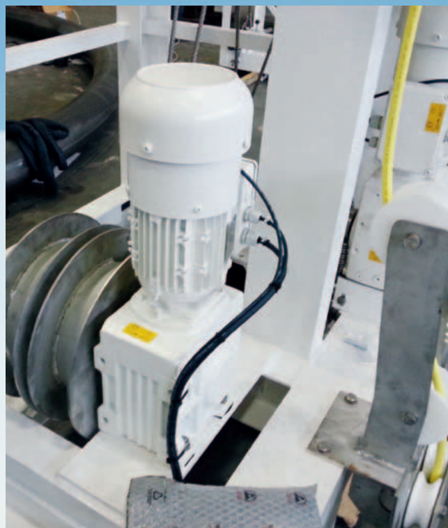
Motoriduttore a vite senza fine autofrenante IP66 con doppio coprivotola (RDD) per uso in ambiente esterno
