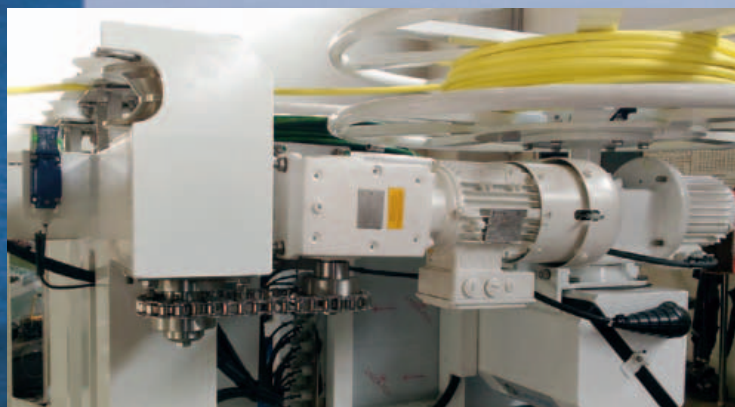
Assemblaggio della macchina lavavetri motorizzata da motoriduttore Nord con trasmissione a catena
