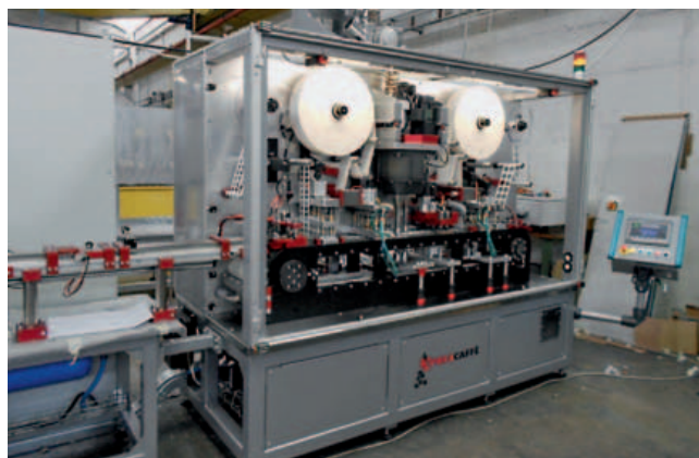
La SR 120/CF è una macchina di tipo lineare per il confezionamento di capsule rigide, a due piste, in grado di riempire e chiudere con un film in alluminio 120 capsule di caffè al minuto
