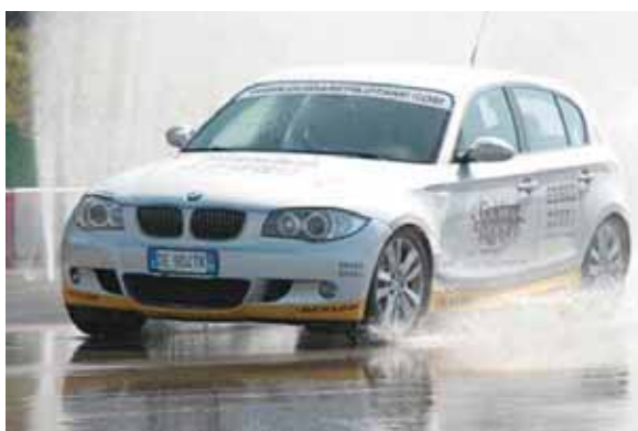
Nell'area del paddock 2 dell'autodromo di Imola vengono effettuati i test di aquaplaning
