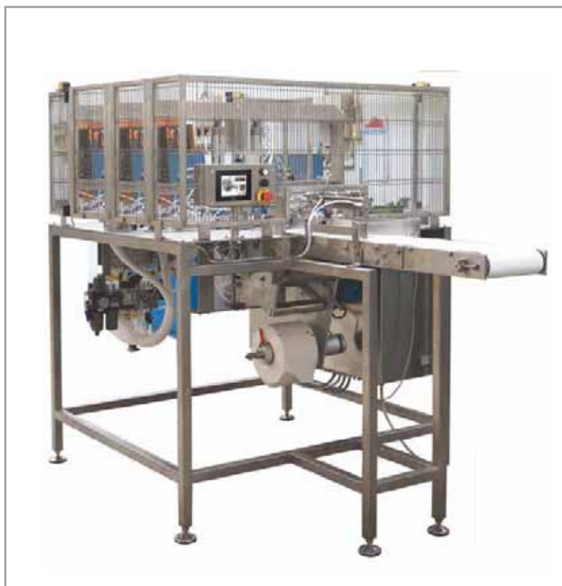
Con PLC e touchscreen Panasonic si esegue il controllo automatico del processo di incarto di formaggi di differente forma e dimensione, nonché il conteggio di produzione e la diagnostica della macchina
