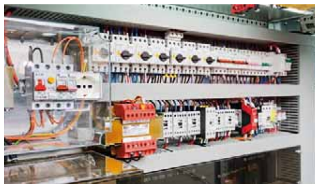
Gli interruttori per protezione motore PKZO controllano i motori dell'estrusore, proteggendoli da guasti e malfunzionamenti
