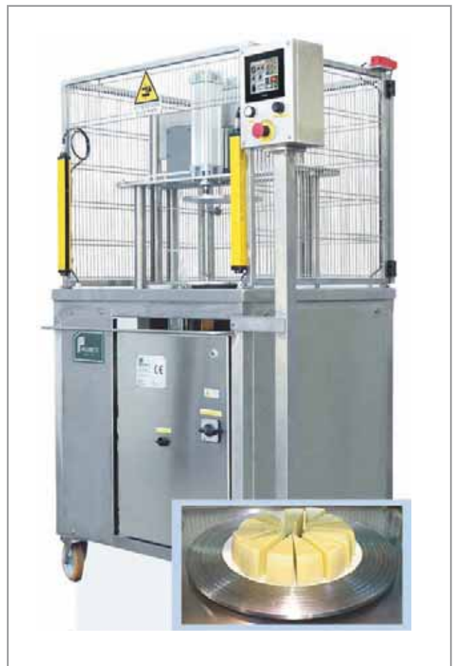
Porzionatrice a spicchi 'elettronica' di Facchinetti basata su PLC e touchscreen Panasonic per il taglio di una forma tonda di formaggio
